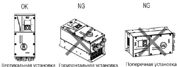
Рис 4.1 Ориентация ПЧ при установке
