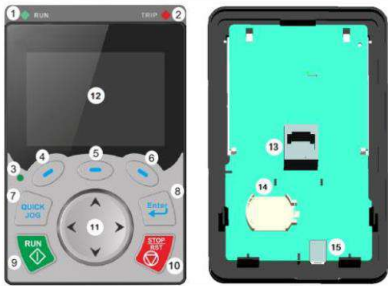
Рис 5.1 Панель управления (внешний вид)
